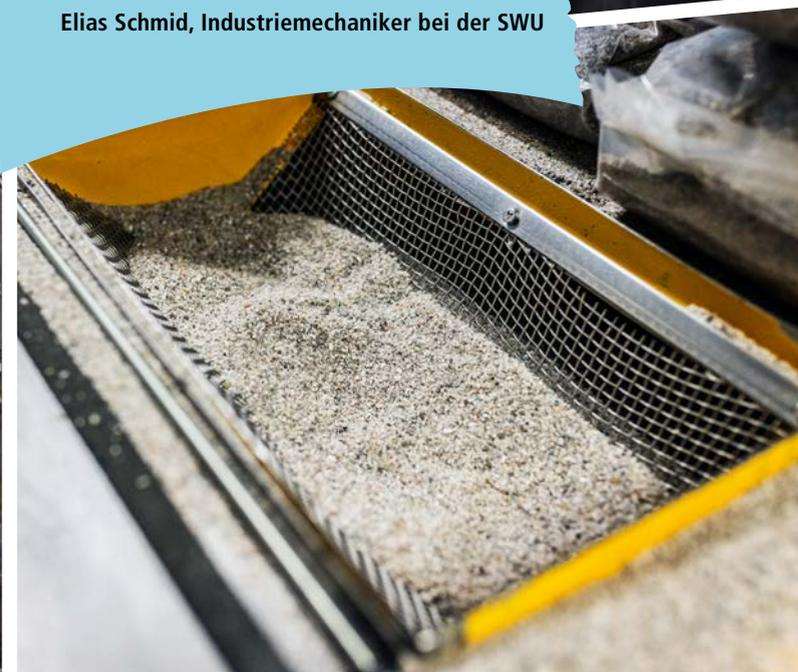
Spezieller Quarzsand sorgt dafür, dass Straßenbahnen auch bei Nässe bremsen.
