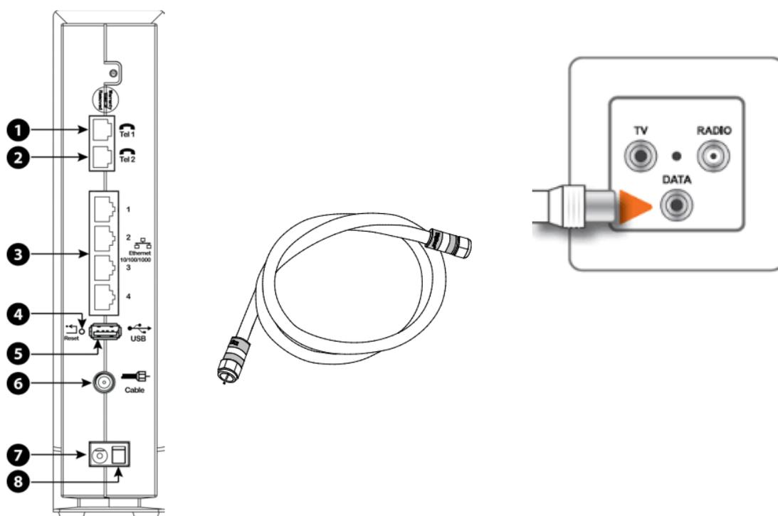
Verbinden Sie Ihren ARRIS WLAN-Router von der **Buchse „6“** mit der **DATA-Buchse** von der Multimediadose. Verwenden Sie dazu das beiliegende Koaxialkabel.
