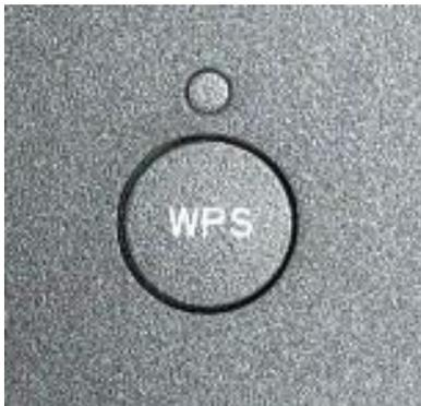
Für die Verwendung drücken Sie auf die WPS-Taste am Router (siehe Abbildung links). Die WPS-LED blinkt für 2 Minuten.
