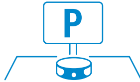
Einzelsensoren je Stellplatz LoRaWAN, kabellos, autark
